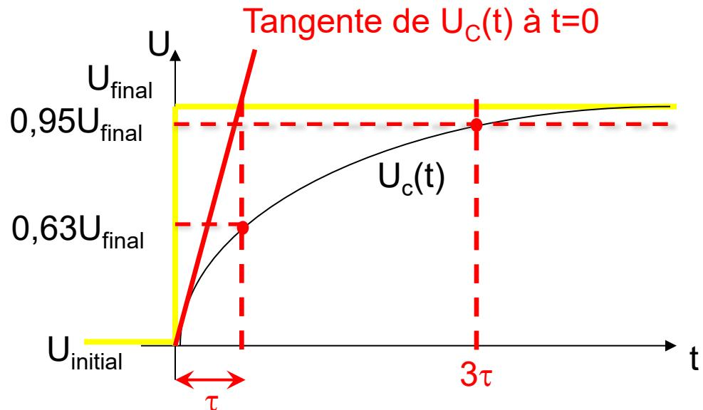
Lorsqu'on applique un échelon de tension à un circuit RC, on a :
