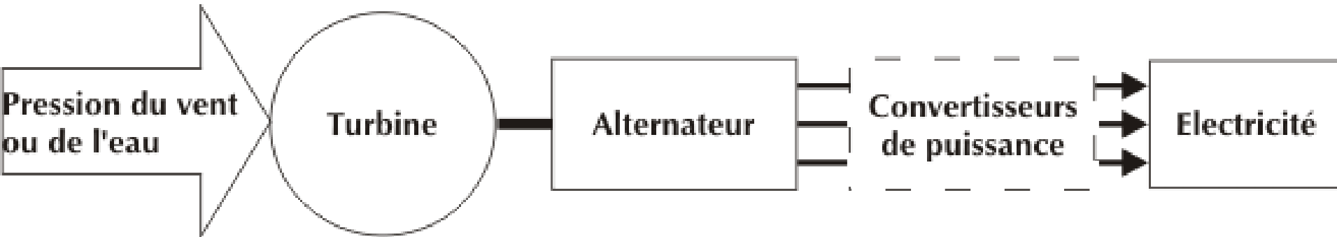
Chaîne éolienne ou hydraulique de production d'électricité
