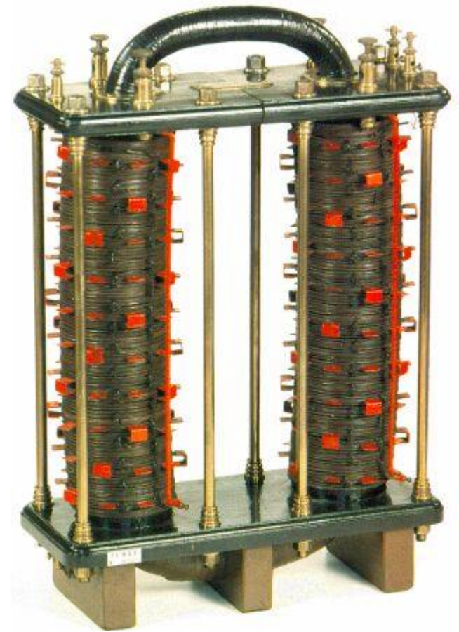
Transformateur à circuit magnétique fermé (1886)
