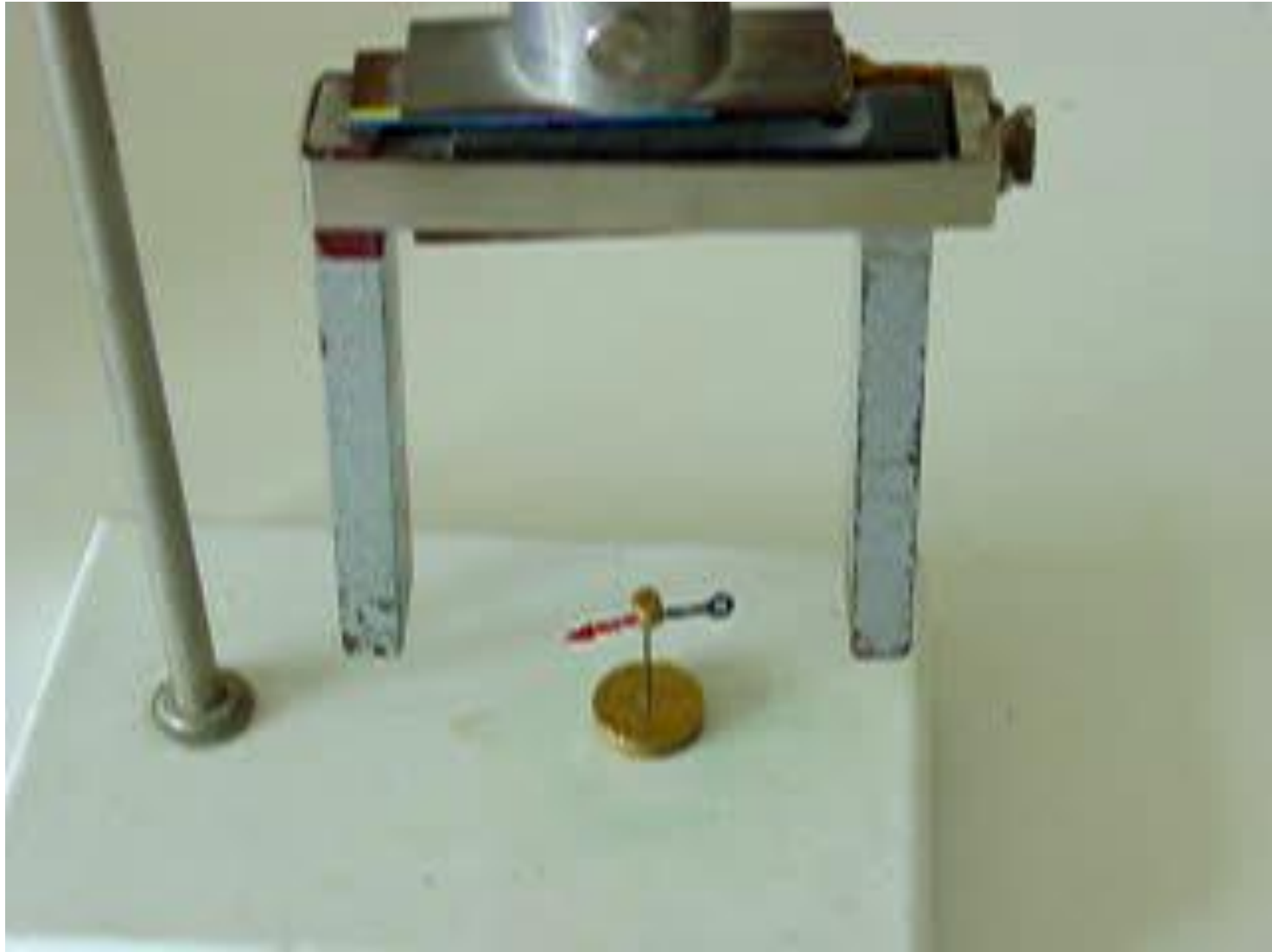
Principe de fonctionnement d'une machine synchrone 13
