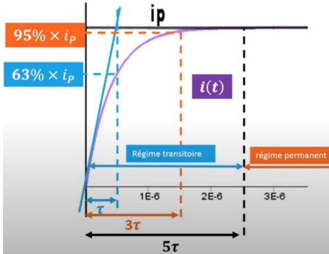
$$\left. \frac{di}{dt} \right|_{t=0^+} = \frac{E}{L} \quad \tau = \frac{L}{R} : \text{temps de relaxation ou constante de temps du circuit } R,L.$$
